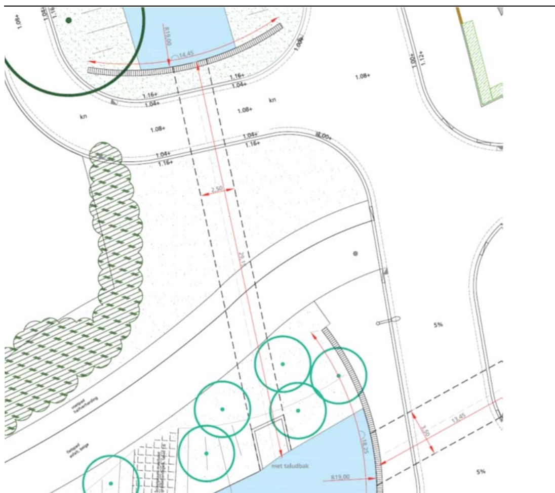
Figuur 3.7 Bovenaanzicht duikerdam conform DOIP
