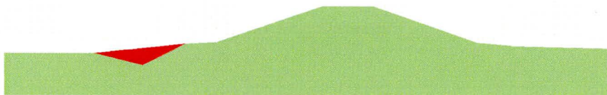
Figuur 3.4 Principe tekening dempen strang/voorland met klei
