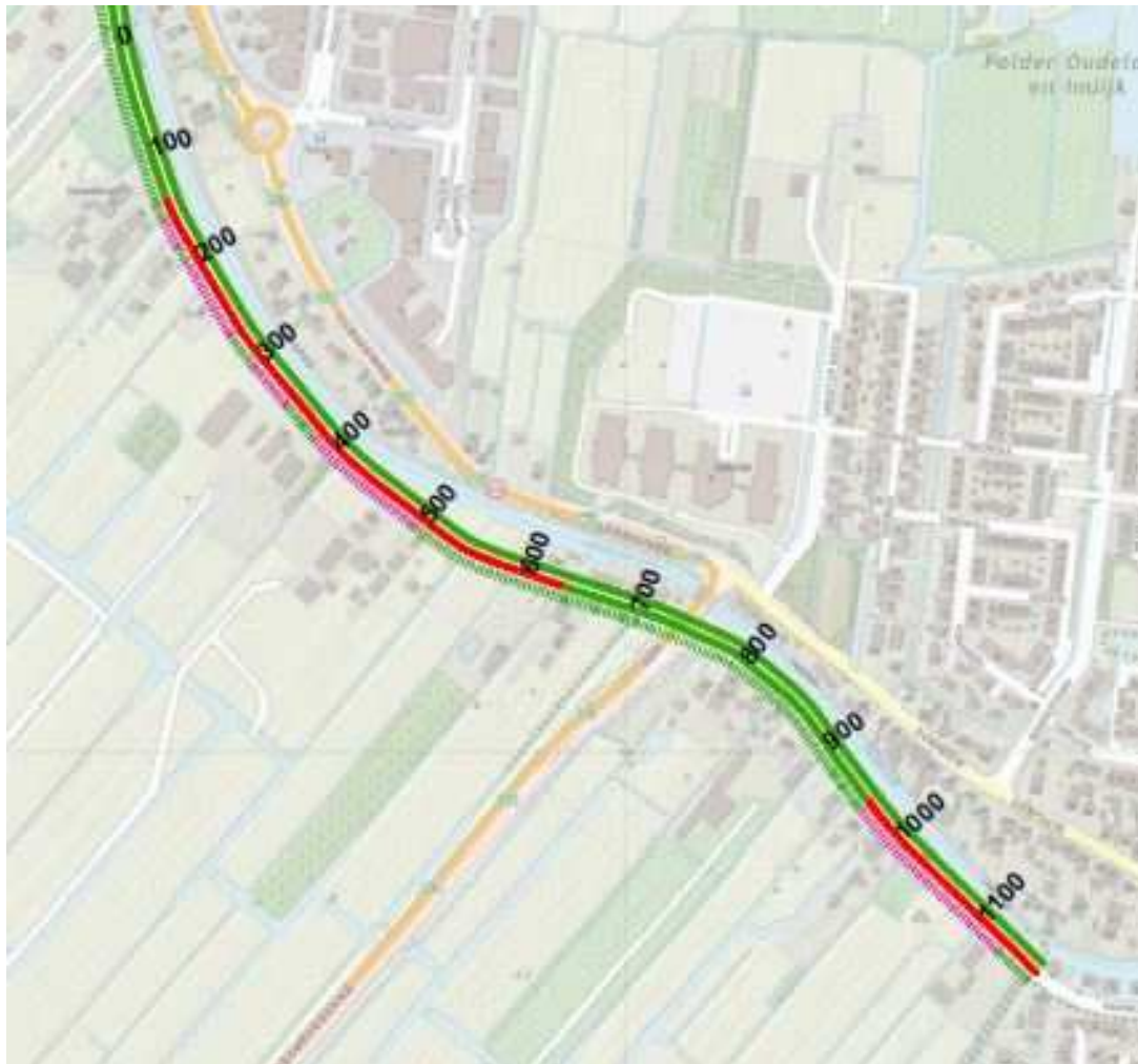
Figuur 9: Eindresultaat toetsing voor dijkvak Haanwijk. Op de groene stukken voldoet de dijk aan de veiligheidseisen. Op de roze stukken voldoet de dijk niet aan de eisen voor stabiliteit binnenwaarts. Op de rode stukken voldoet de dijk niet aan de eisen voor hoogte.
