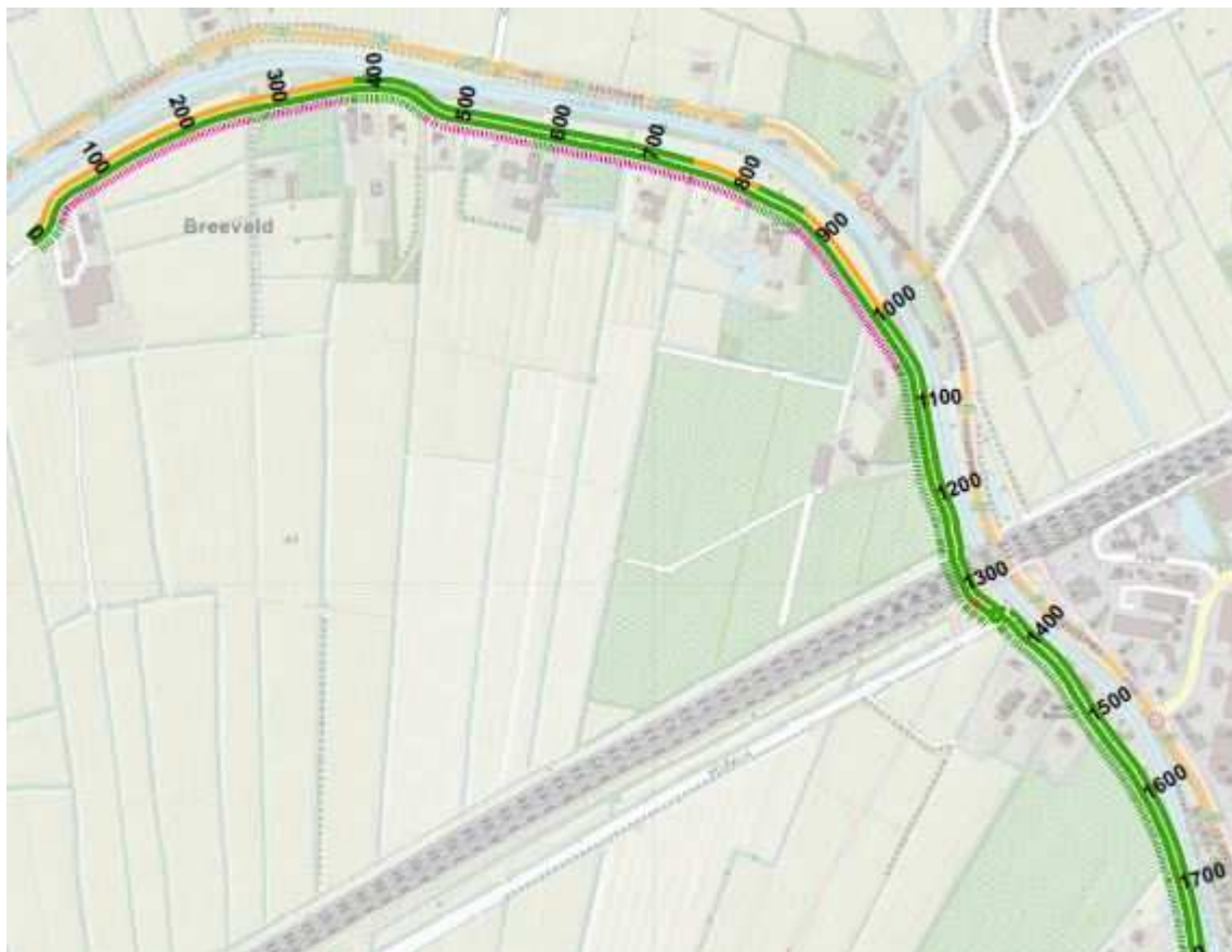
Figuur 5: Eindresultaat toetsing voor dijkvak Breeveld. Op de groene stukken voldoet de dijk aan de veiligheidseisen. Op de roze stukken voldoet de dijk niet aan de eisen voor stabiliteit binnenwaarts. Op de oranje stukken voldoet de dijk niet aan de eisen voor piping.
