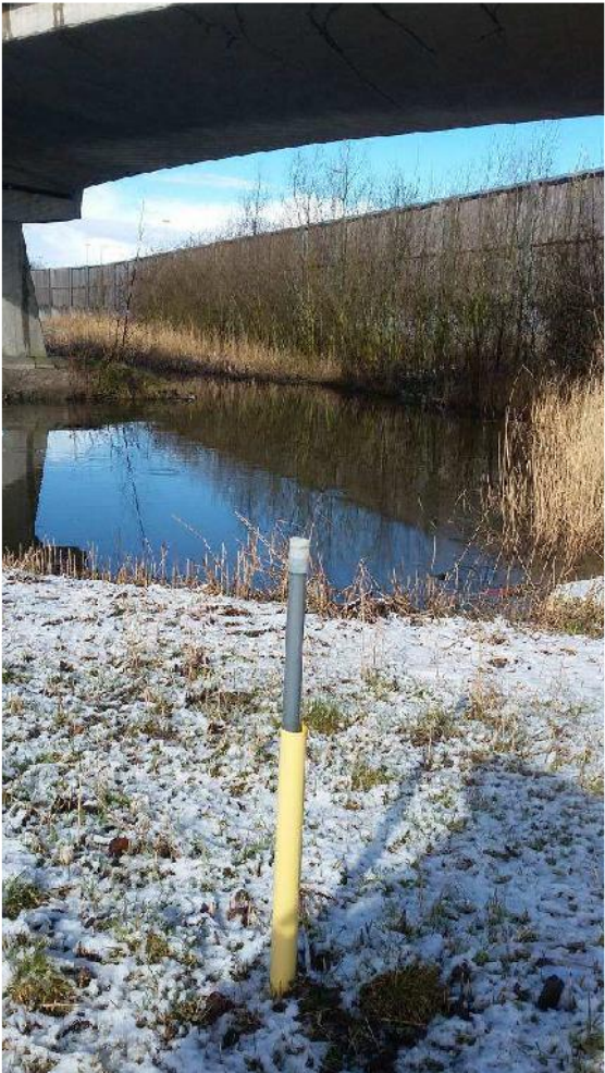
Foto 9: Peilbuis (vermoedelijk) binnen het tracé van de beoogde nieuwe leiding
