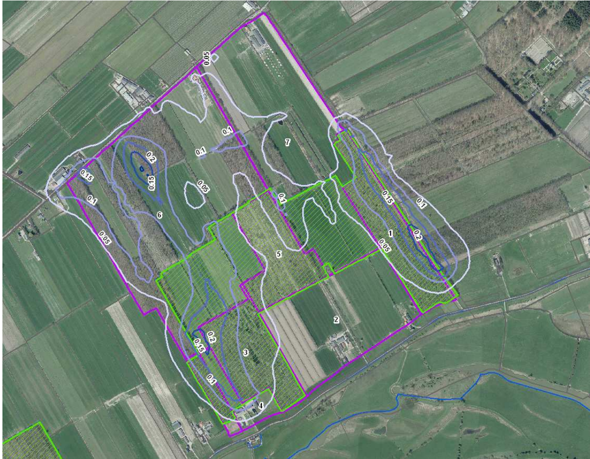
Afbeelding 4: Effect van de maatregelen op de grondwaterstand in de GLG situatie (Gemiddelde Laagste Grondwaterstand).
