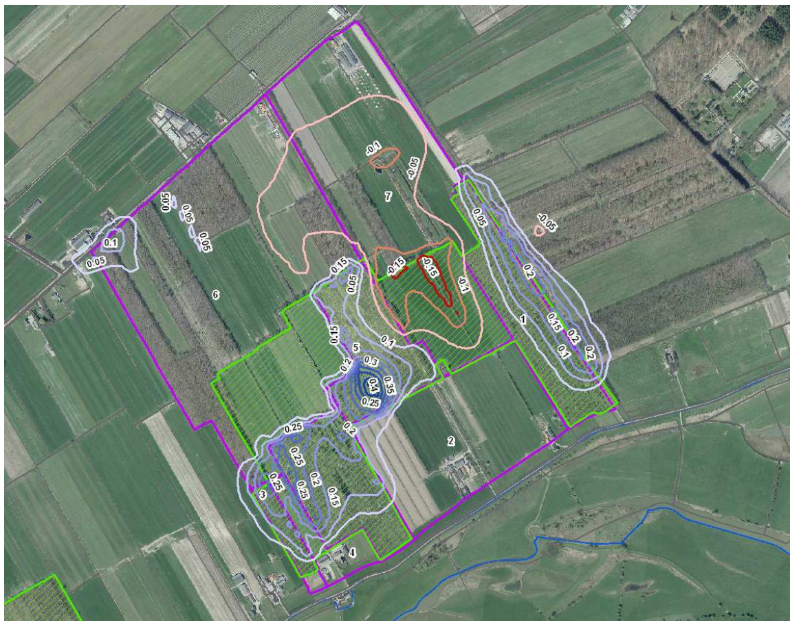
Afbeelding 3: Effect van de maatregelen op de grondwaterstand in de GVG situatie (Gemiddelde Voorjaars Grondwaterstand).
