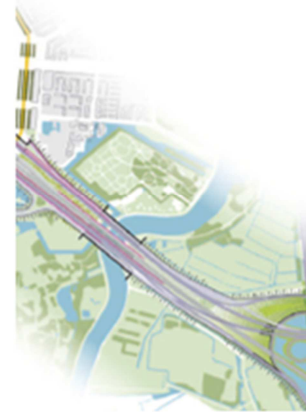
De onderdoorgangen in Zuidasdok met de te verbeden brug over de Schinkel aan de westzijde en de te verbreden brug over de Amstel aan de Oostzijde
