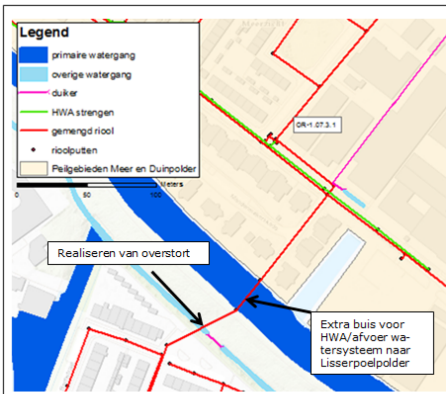
Figuur 5-3; Maatregel voor scenario 3, zuidelijk deel peilvak 3.1. Realiseren van een overstort in de Lisserpoelpolder
