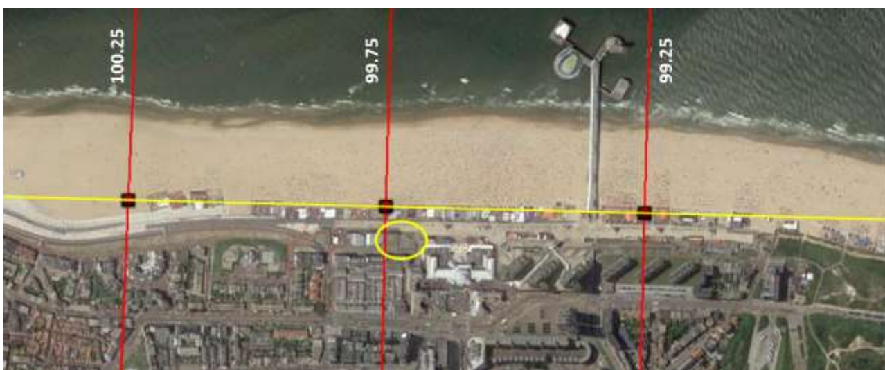
Figuur 1 Locatie voorziene ingreep met de positie van de RSP-lijn (gele lijn evenwijdig aan de kustlijn) en de relevante JarKus-profielen (dwars op de kustlijn aanwezige rode lijnen).
