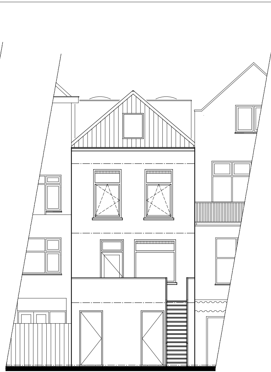
achtergevel nieuw uitbreiding houtskeletbouw bekleed met steenstrips
