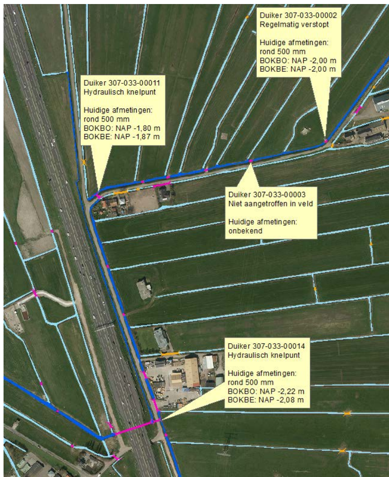
Figuur 5.1: Knelpunten duikers watersysteem Inlaagpolder
