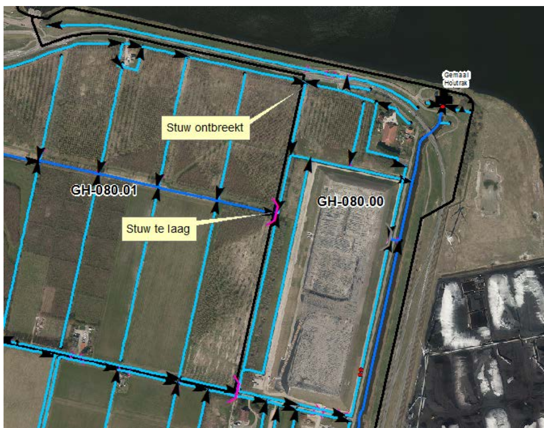
Figuur 5.1: Ontbrekende stuw tussen GH-080.01 en GH-080.00
