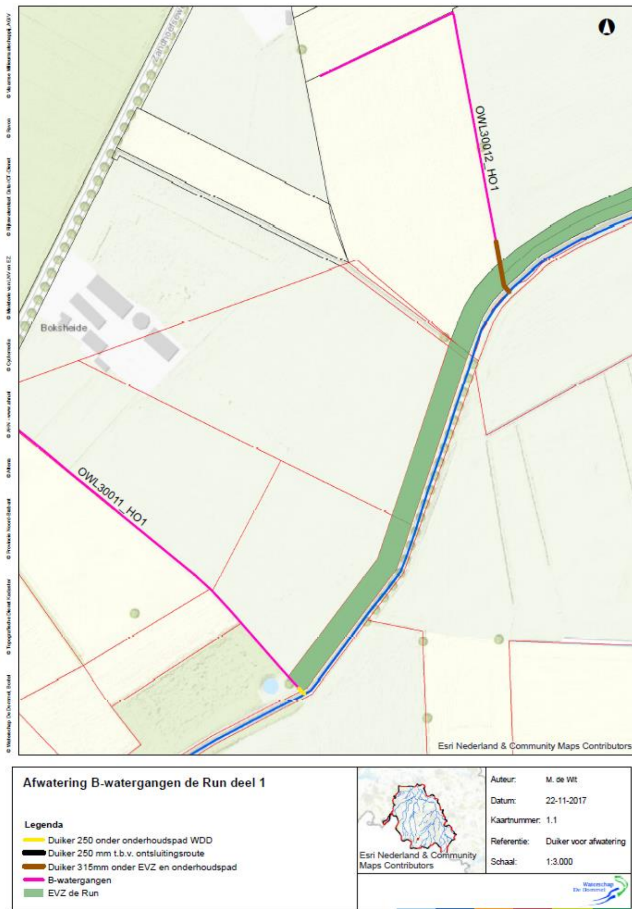
Figuur 1: Aanleg duikers t.b.v. afwatering b-watergangen na inrichting EVZ de Run (deel 1).
