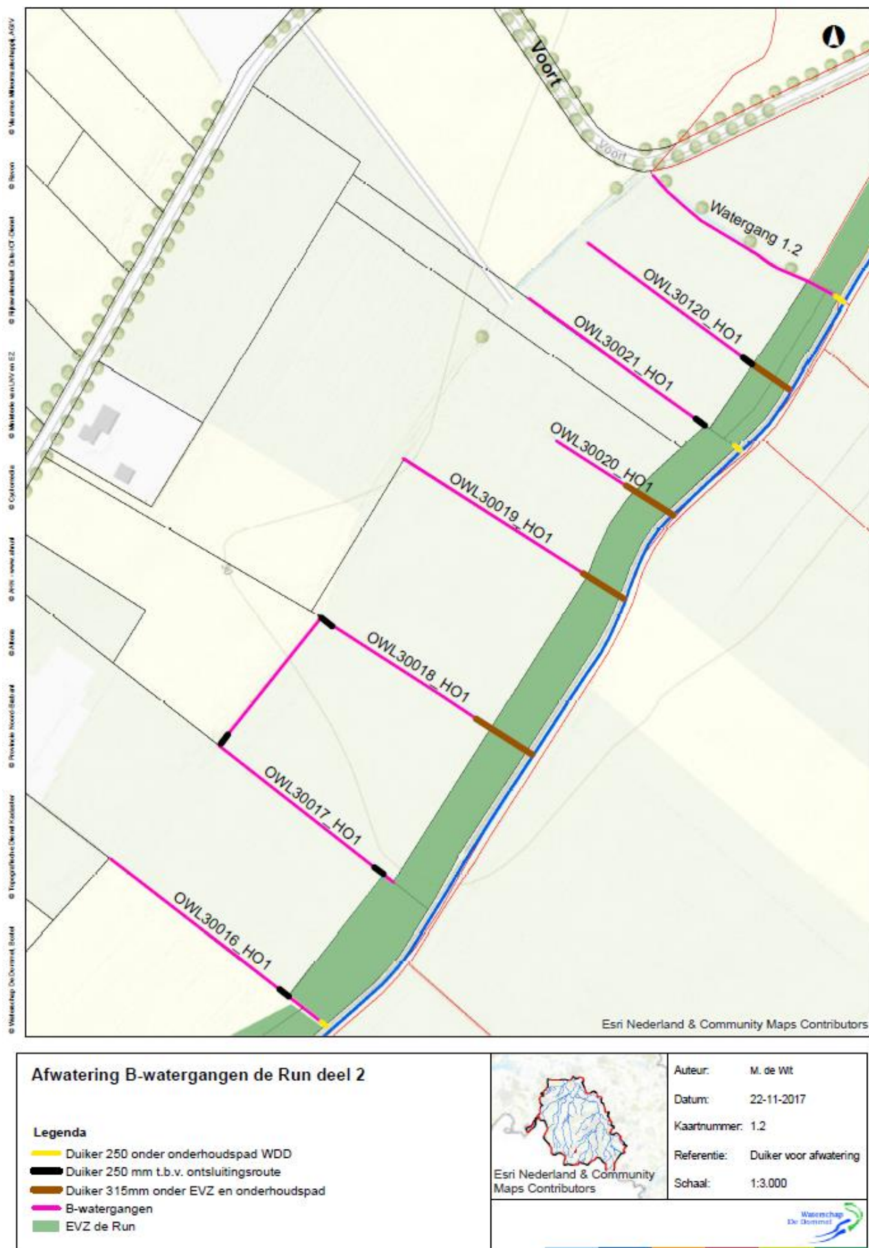
Figuur 2: Aanleg duikers t.b.v. afwatering b-watergangen na inrichting EVZ de Run (deel 2).
