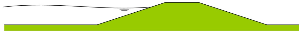
niet verheelde en niet aangeheelde waterkering
