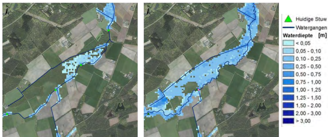
Figuur 3-19. Inundatiebeeld Grootgoor T100Wh huidig (links) en T100Wh Beekherstel (rechts)
