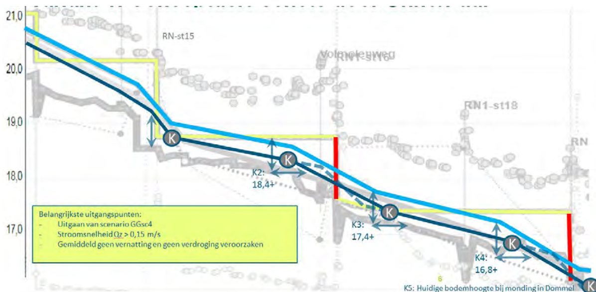
Figuur 3-8 Locatie knikpunten variant 1B in langsvol. De bodemhoogte van de knikpunten is weergegeven in m+NAP
