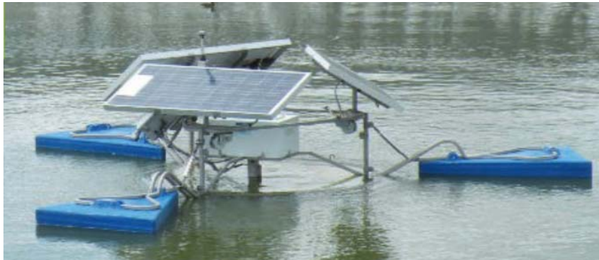
Figuur: LumenAER™ Drijvende installatie op zonne-energie die zorg voor beluchting en circulatie ( www.rwlwater.com ).
