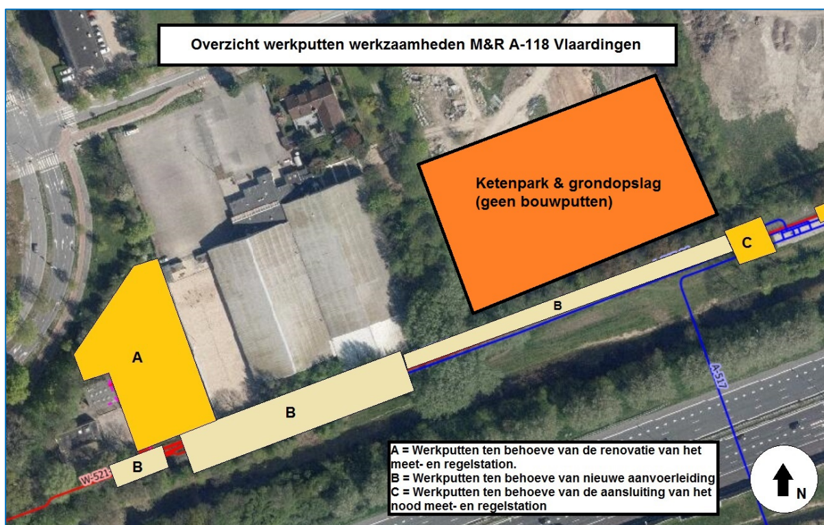
Afbeelding 2; Overzicht bouwputten en ketenpark meet- en regelstation A-118 Vlaardingen.
