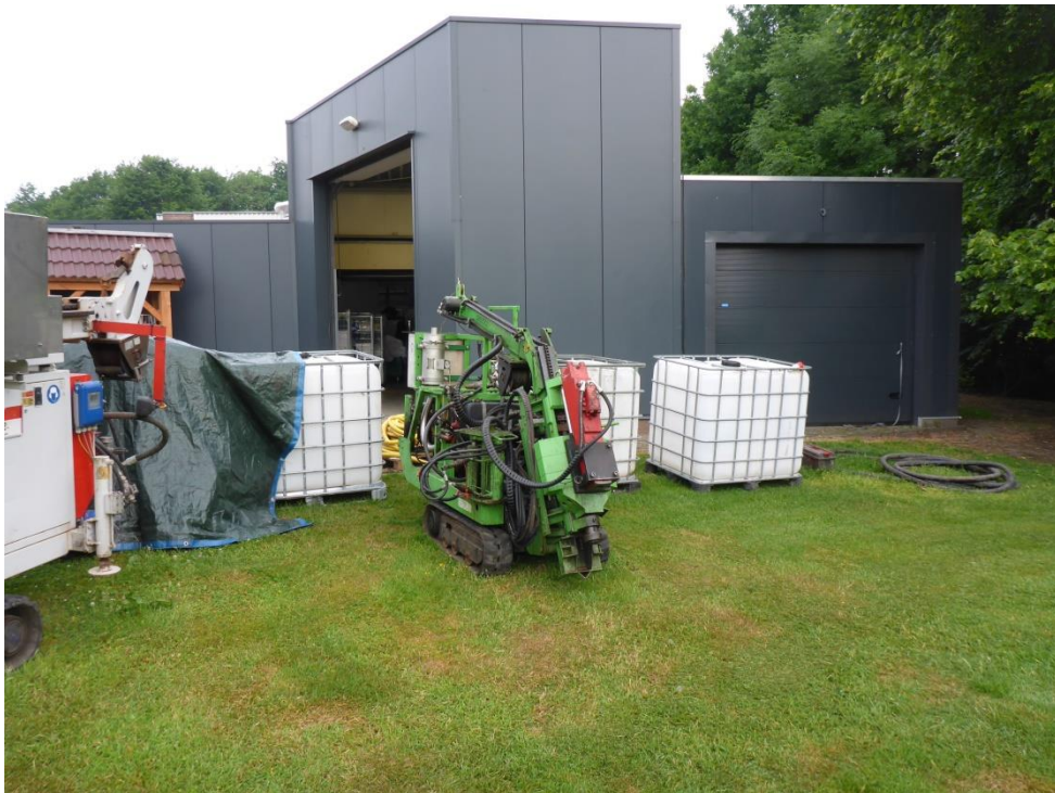
foto 4: P1050831.JPG: Kleine sonic drill voor inpandige injecties.
