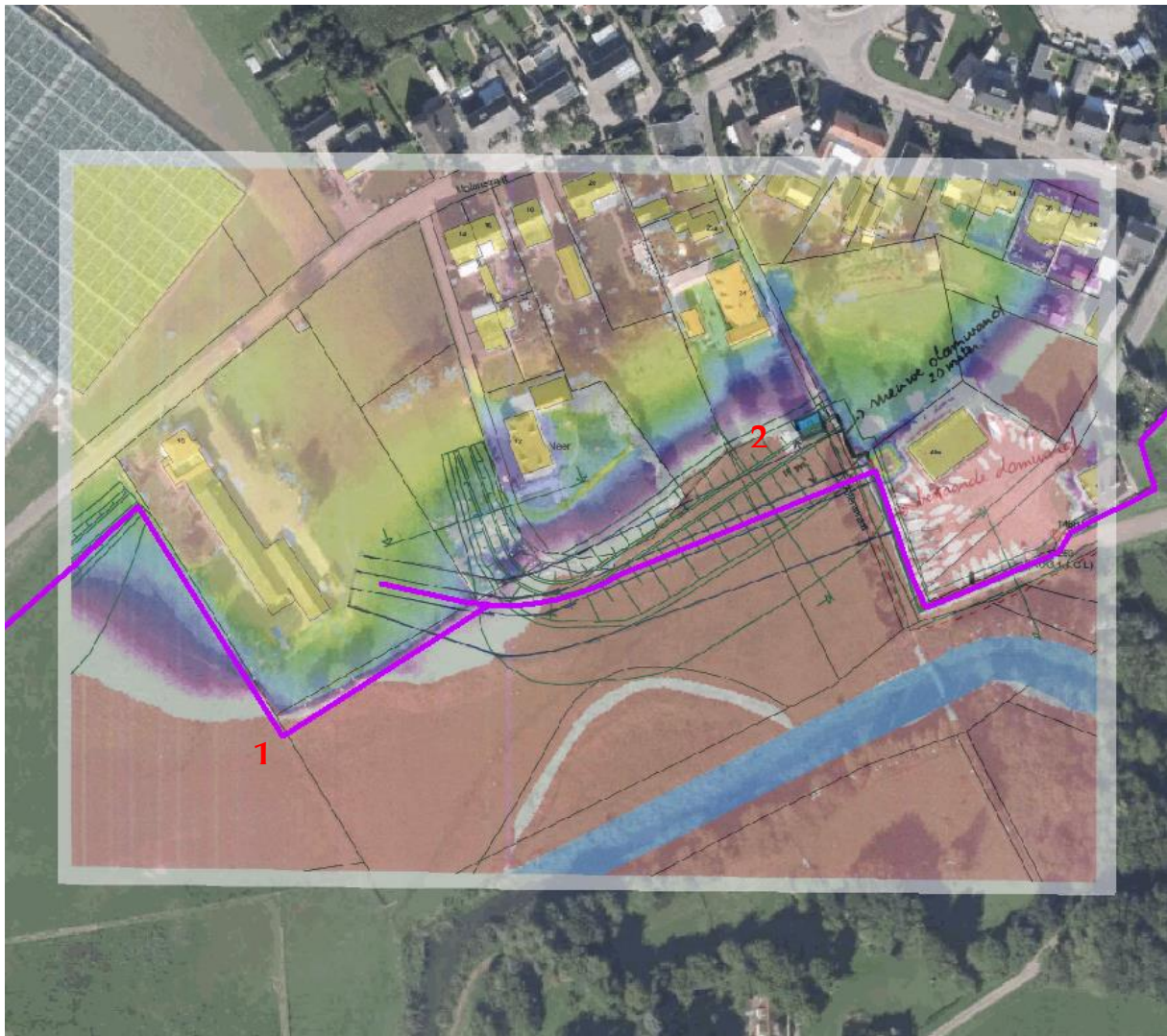
Figuur 2-3 Weergave nieuw tracé dijkversterking Neer, ontwerp dijknee_a5
