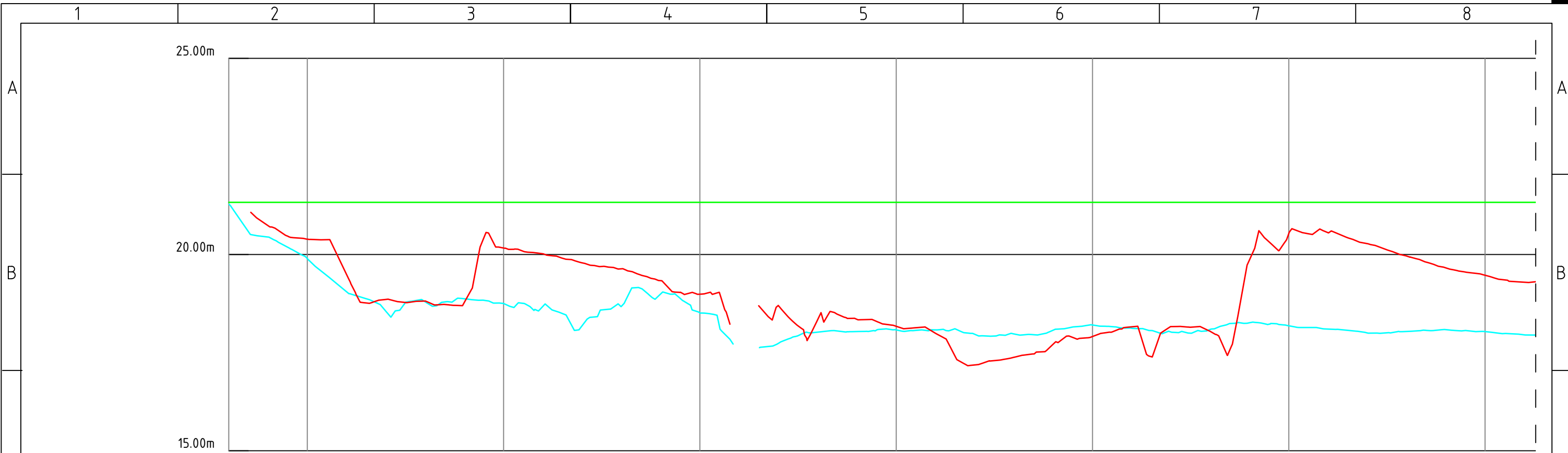
Lengteprofiel as Dijktracé Metrering 74.029+60 t/m 74.047+10
