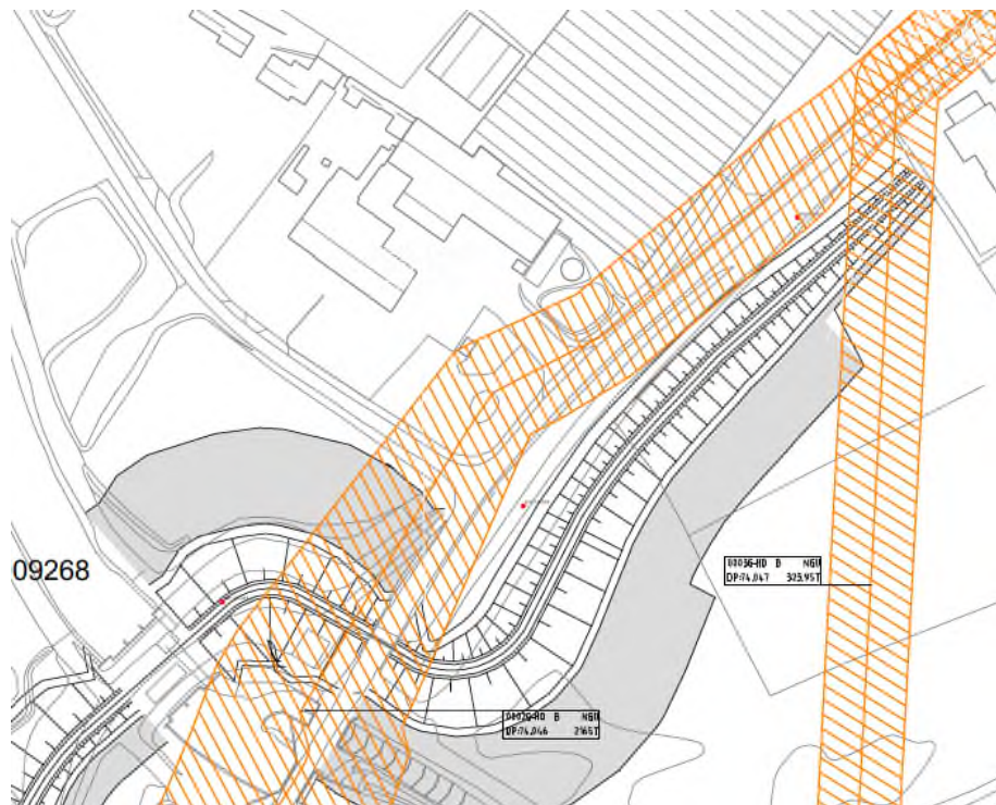
Figuur 4-18: Dijkvak 8; Ligging hoge druk gasleiding NGU en de verstoringzone geprojecteerd op het dijkontwerp.
