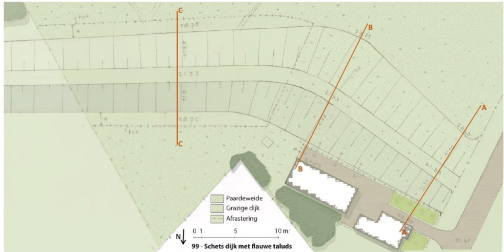
Figuur 4-3: Dijkvak 1, schets van de inpassing van de dijk met paardenovergang. (bron: (Waterschap Peel en Maasvallei, 2016))
