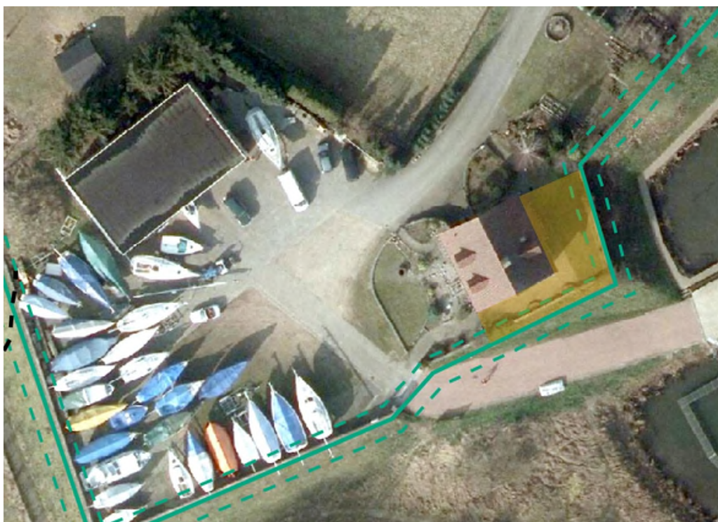
Figuur 4-21: Dijkvak 10b; Indicatie van het op te hogen maaiveld in de tuin van de woning Hanssum 40A.
