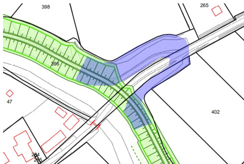
Figuur 4-8: Dijkvak 4: Voorlopig ontwerp (groen) met in blauw een indicatie van het tracé van de huidige dijk.
