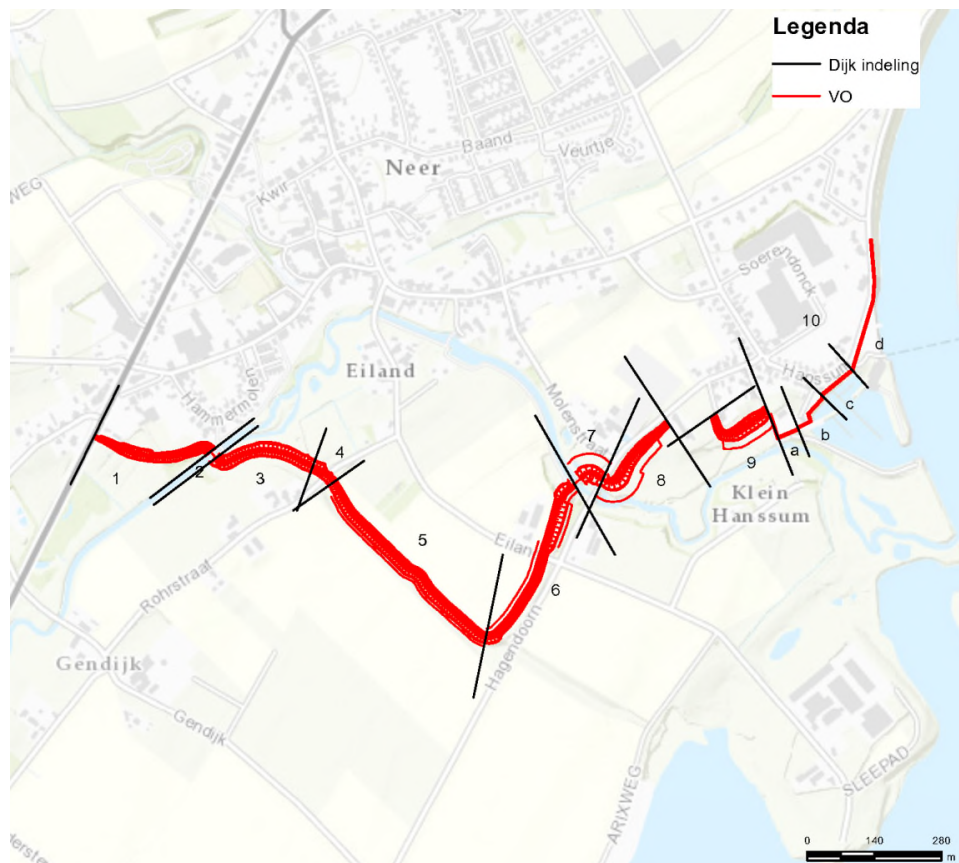
Figuur 3-3 Indeling dijkkring 74 in dijkdelen
