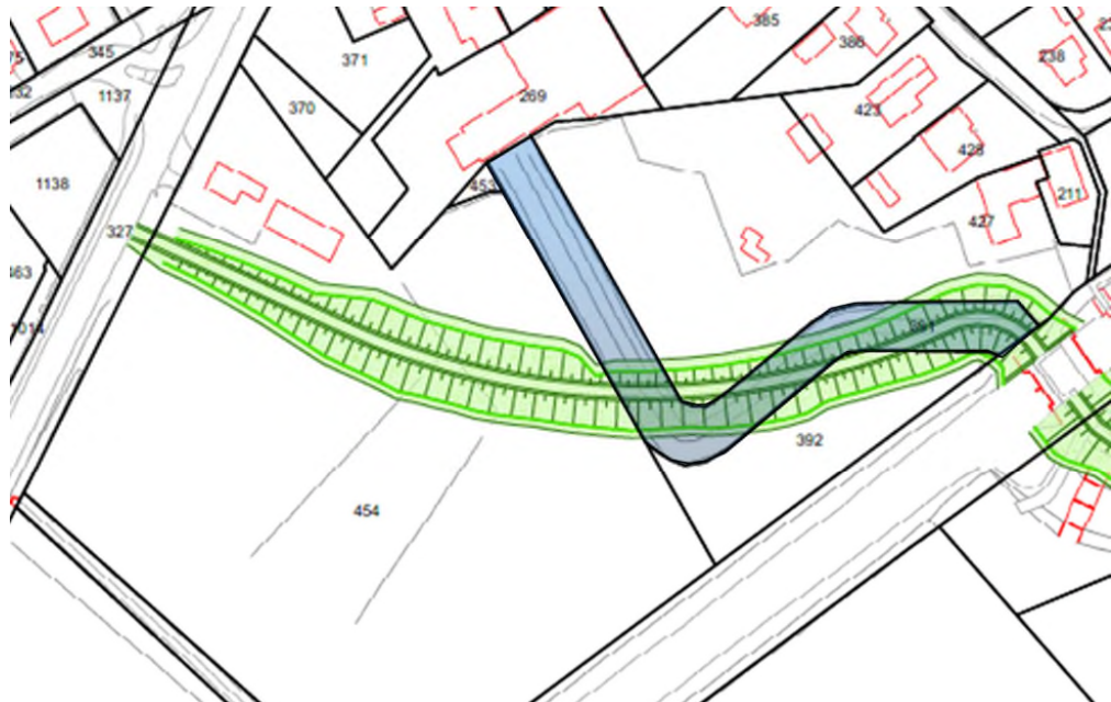
Figuur 4-1: Dijkvak 1; Voorlopig Ontwerp van de aansluiting van huidige dijk op hoge gronden middels een groene kering, met in lichtblauw het traject van de huidige kering.
