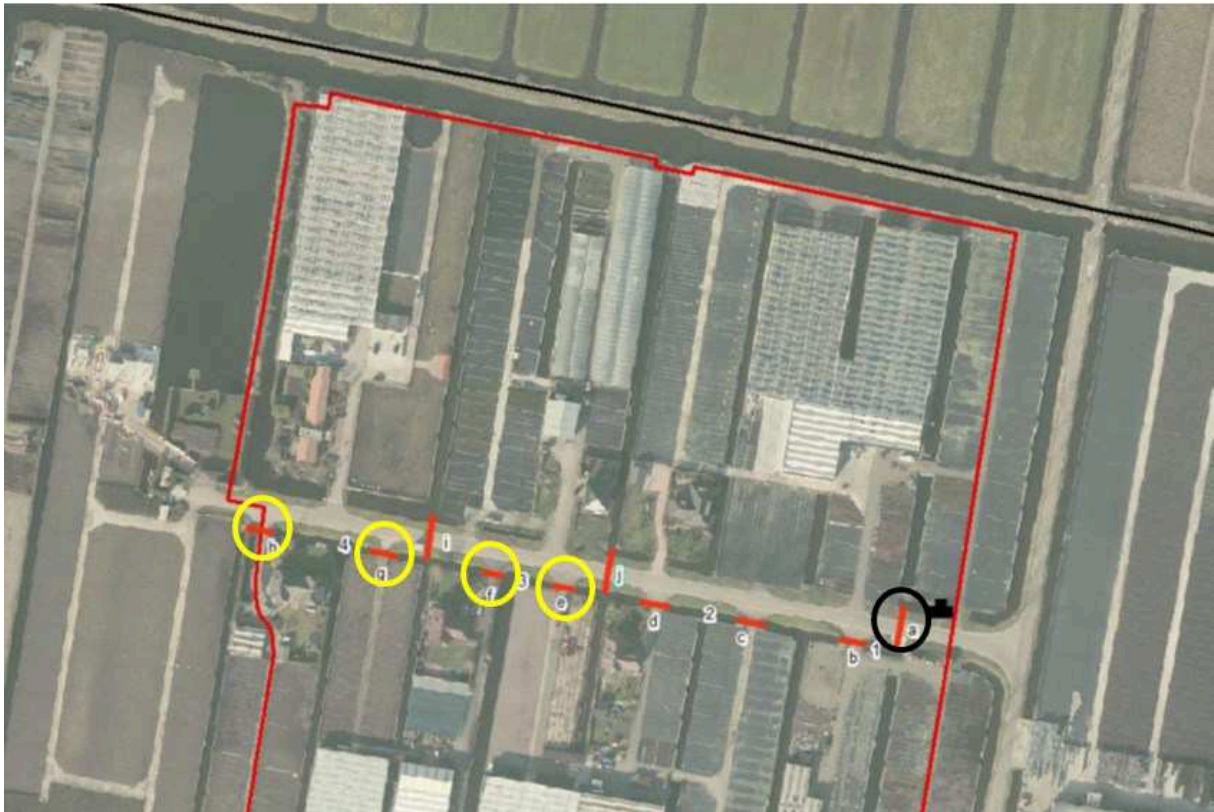
Figuur 2.2: Ligging te vervangen duikers parallel aan het Koetsveld (gele cirkels) en aan te brengen nieuwe duiker onder het Koetsveld (zwarte cirkel (bron: projectkaart WGP Greenport Boskoop – Noord).
