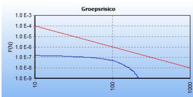
Figuur 17 FN-curve van de kilometer met de hoogste overschrijdingsfactor van gastransportleiding W-521-28_combi_stationing_herb in de toekomstige situatie. De ligging van deze kilometer is hiernaast in het groen weergegeven op een topografische kaart.
