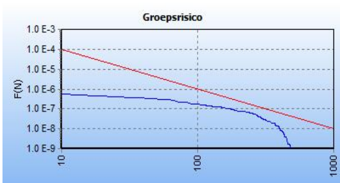
Figuur 11 FN-curve van de kilometer met de hoogste overschrijdingsfactor van gastransportleiding W-521-28 in de huidige situatie. De ligging van deze kilometer is hiernaast in het groen weergegeven op een topografische kaart.
