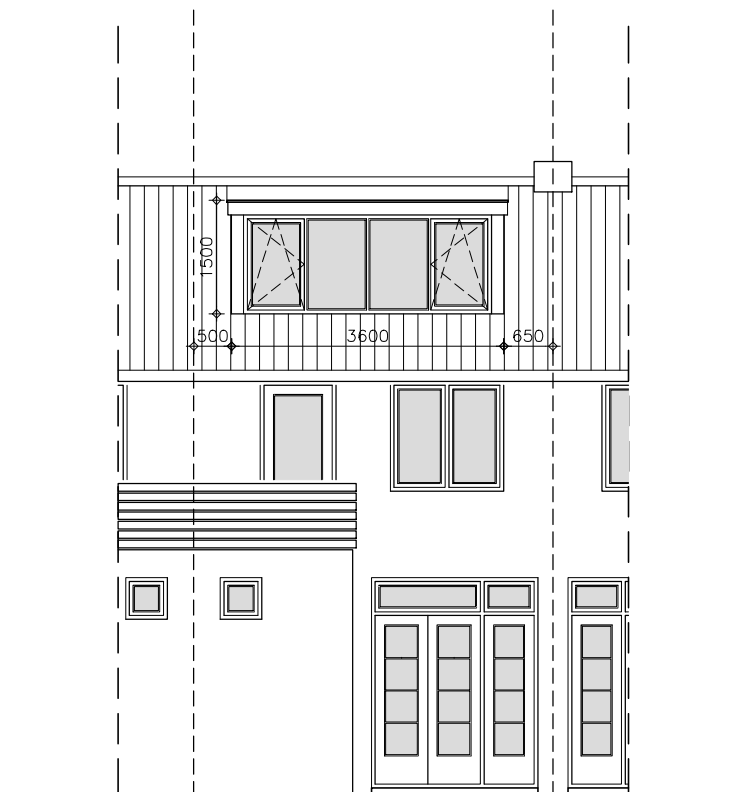
Achtergevel (Nieuwe situatie)
