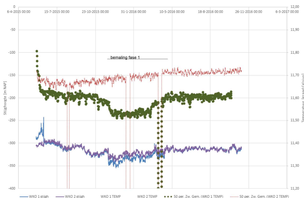
Figuur 7-6 Monitoring stijghoogte (op linkeras) en temperatuur (rechteras) bij Atrium
