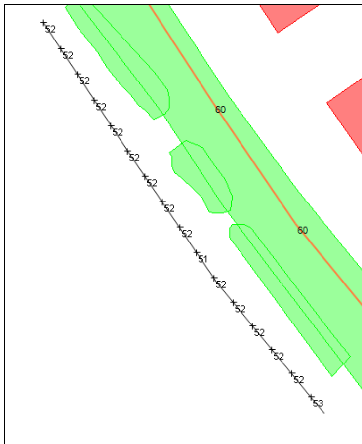
Figuur 4 Hoogst berekende geluidbelastingen op de rooilijn van 16 m uit het hart van de Hegsestraat
