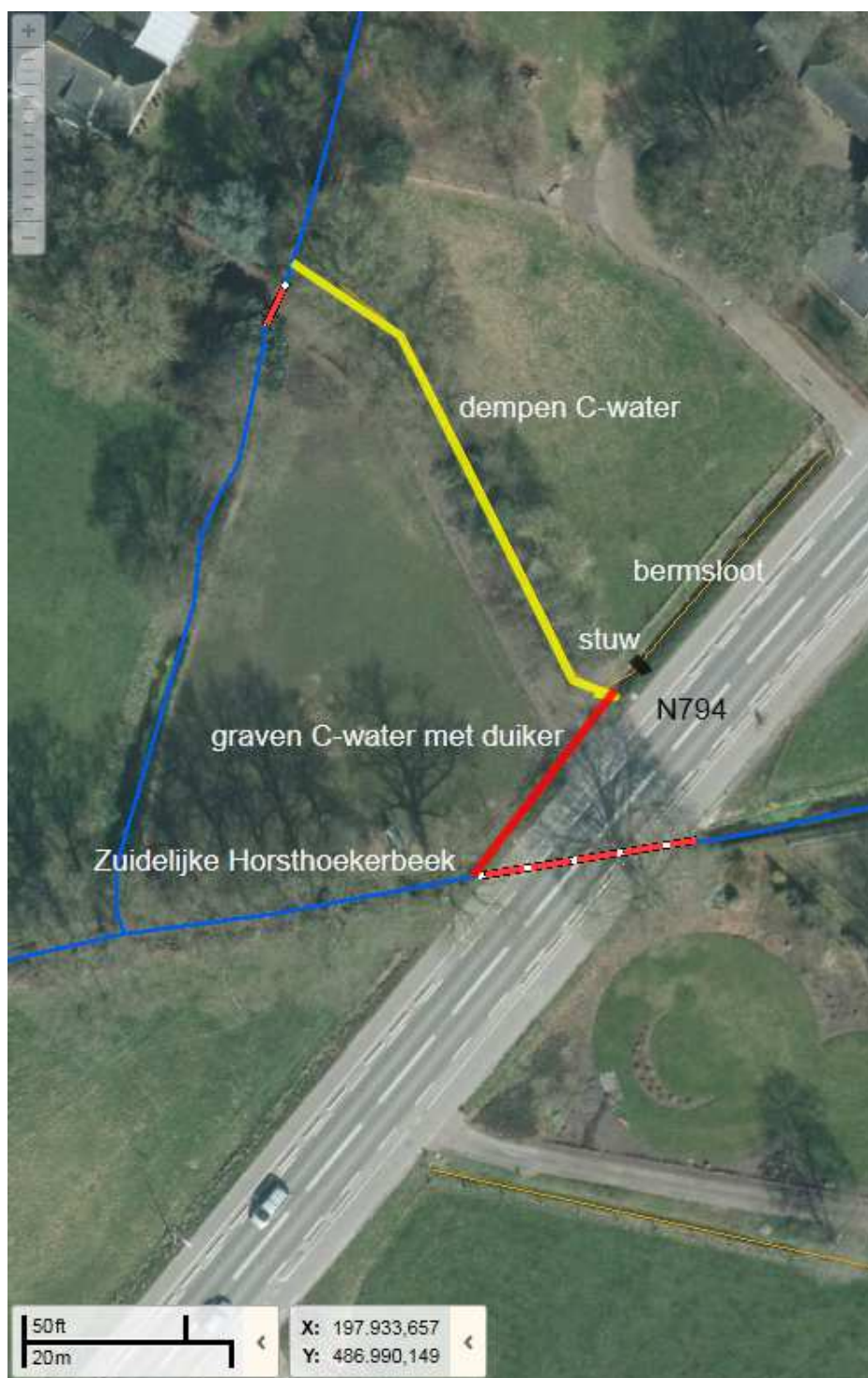
verleggen oppervlaktewaterlichaam C, aanbrengen stuw en leggen duiker
