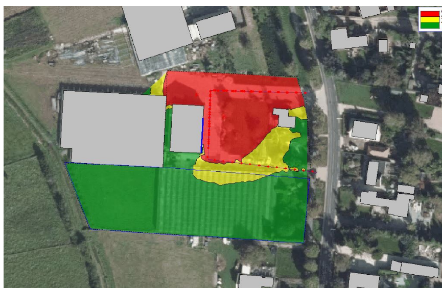
Figuur 10 Berekende langtijdgemiddelde beoordelingsniveaus (L Ar ,L T ) in de dagperiode (rekenhoogte 1,5 meter) ter plaatse van plangebied (blauwe kader, dunne lijn) en de directe omgeving
