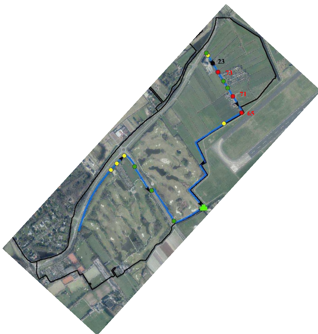
Figuur 1-3 Ligging van duikers met te grote opstuwing (zwart > 20 mm; rood \geq 10 mm; geel \geq 5 mm)
