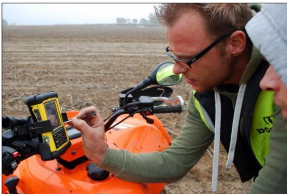
Figuur 3: Veldcomputer VFC2, registratie van anomalieën (foto Bom-Be)
