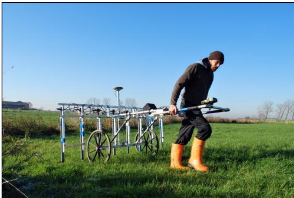
Figuur 2: Inzet multisonde, handkar (foto Bom-Be)
