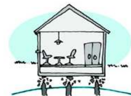
Grondwaterpeil te laag: paalrot
