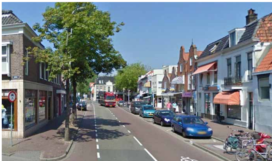
Deze bomen in de Nieuwstraat staan duidelijk te dicht bij de gevels. Bovendien staan ze vol in de verharding. Ze geven hinder, zullen niet volwassen worden en vaak ziek zijn.
