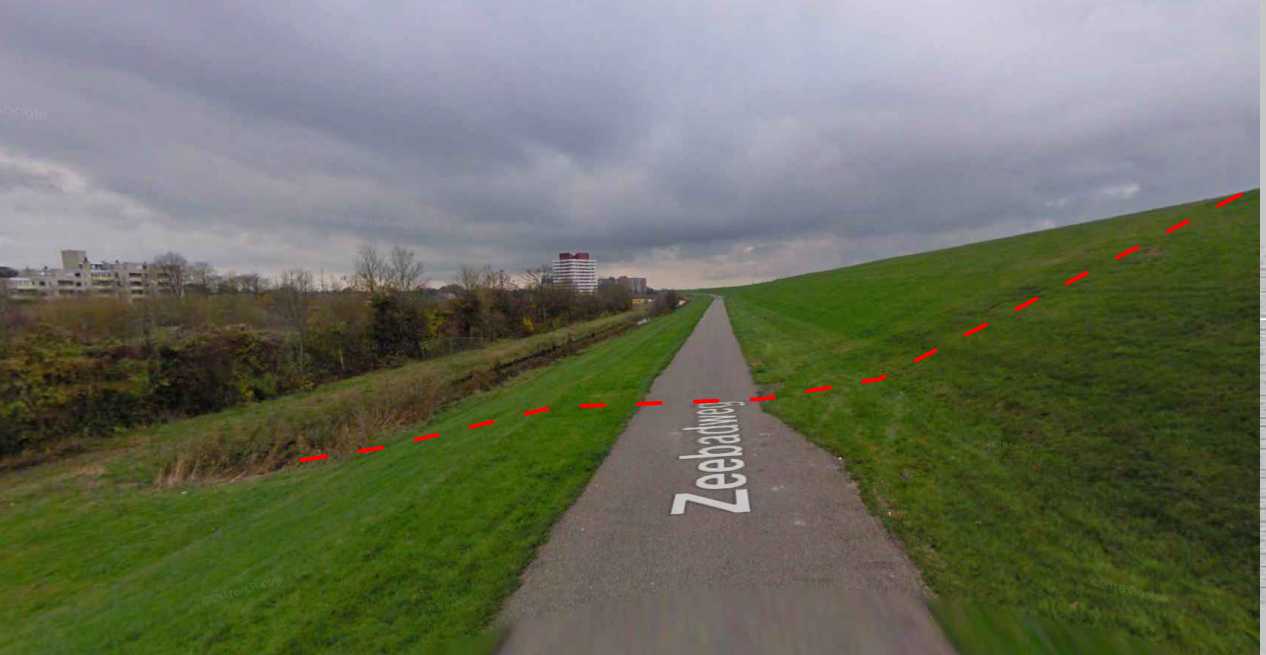
T.p.v. roep lijn, bouwhekken plaatsen (Geschoord). Linkerzijde tot op waterlijn sloot. Rechterzijde tot op het wad. T.p.v. onderhoudsweg 2 x draaislot hek. Tijdens werkzaamheden (tijdelijk afsluiting) is het hek open. Na werk is het hekwerk deels dicht met slot. Sleutel van het hekwerk in sleutelkastje bij poort aanwezig. Pincode sleutelkastje wordt gecommuniceerd met betreffende partijen
