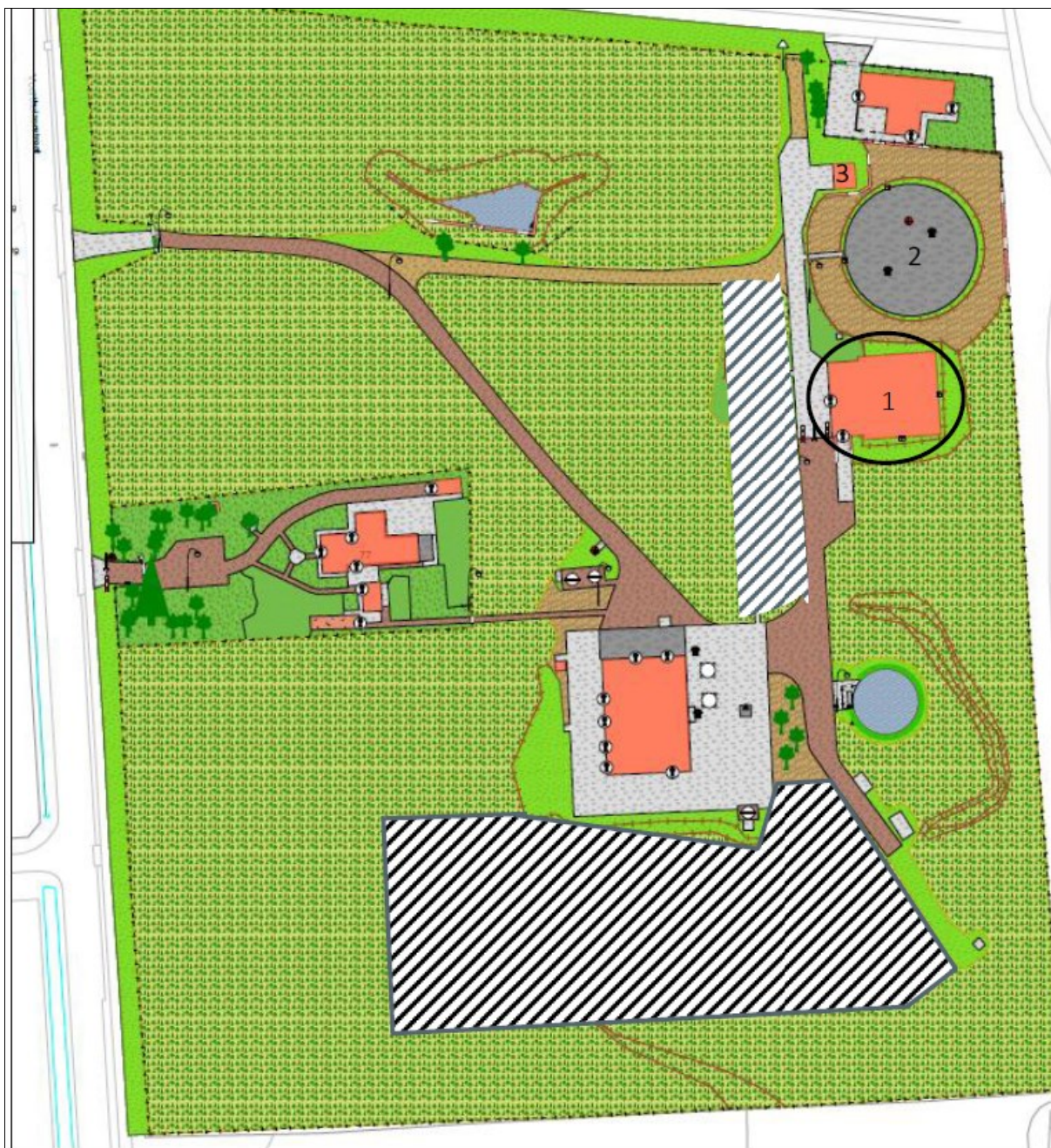
Figuur 2: Ligging van de reinwaterkelder (1), de slibvijver (2) en het schuurtje (3), die gesloopt gaan worden en de ligging van het te kappen bos aan de zuidzijde van het terrein (gearceerde deel). Voorts wordt een strook bos gekapt ten westen van de slooplocatie (ook gearceerd).
