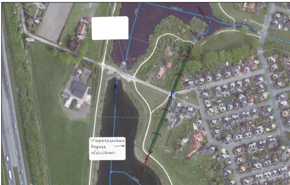
Figuur 3.6: maatregelen stuwconstructie 'Patatkraam'
