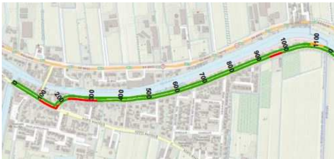
Figuur 5: Eindresultaat toetsing dijkvak Hoge Rijndijk. Op de groene stukken voldoet de dijk aan de veiligheidseisen. Op de rode stukken voldoet de dijk niet aan de vereiste hoogte. Op het oranje stuk voldoet de dijk niet op piping.
