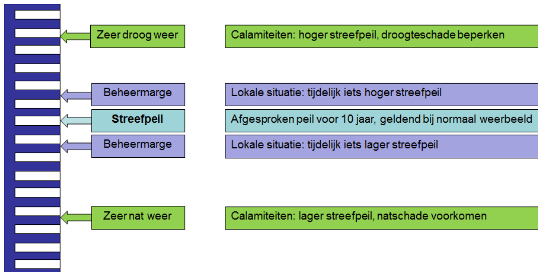
Figuur 2: Schematische weergave streefpeil en beheermarges
