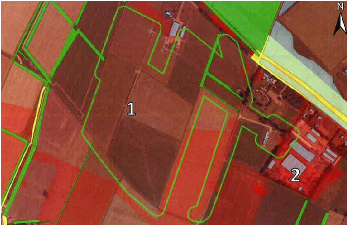
Figuur 19: In verschillende tinten rood zijn de verdachte gebieden aangegeven, waarbij deelgebied 1 verdacht is op de aanwezigheid van (verschoten) geschutmunitie van diverse kalibers, tot een diepte van 2,5 m-mv.
