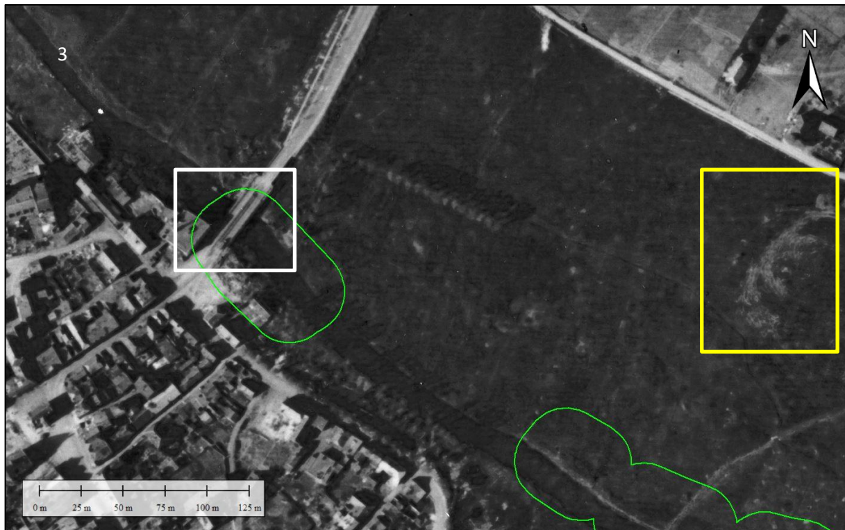
Figuur 25. Binnen het witte kader is de Baileybrug te zien die tijdens het Geallieerde offensief over de Niers gebouwd is. In het gele kader zijn de sporen van rupsbanden van zware voertuigen waar te nemen. In het gehele gebied zijn enkele gaten van artillerie inslagen te zien. Luchtfoto 17 april 1945
