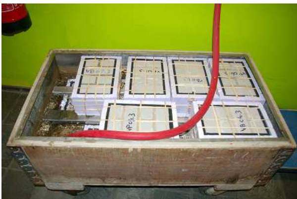
voorbereiding proefstukken voor vriesdooiproef bij TNO Bouw en Ondergrond
