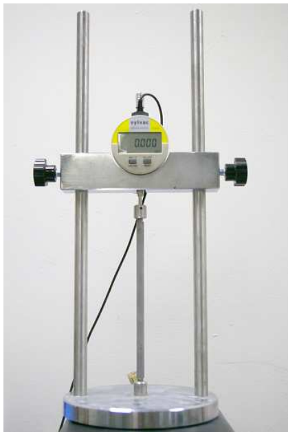
testopstelling met calibratie staaf voor de vastlegging van de 0-stand
