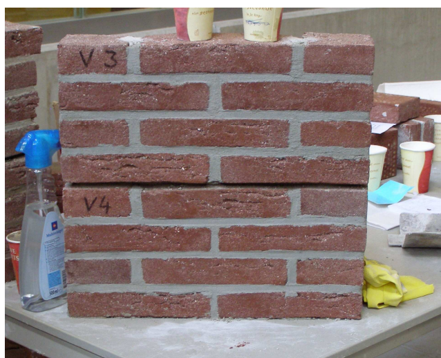
voegwerk gereed na uitvoeren verwerkbaarheidsproef; mortelnummers genoteerd
