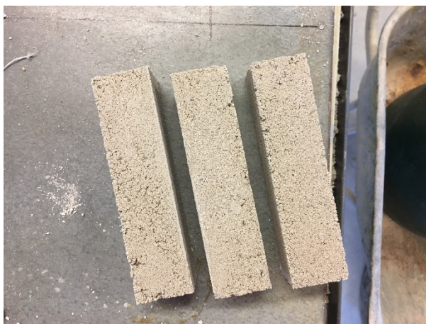
Figuur 2.3: De mortelprisma's na ontkisting.
