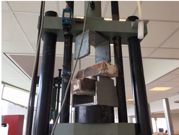
Figuur 3.7: Bezwijken van de proef.
