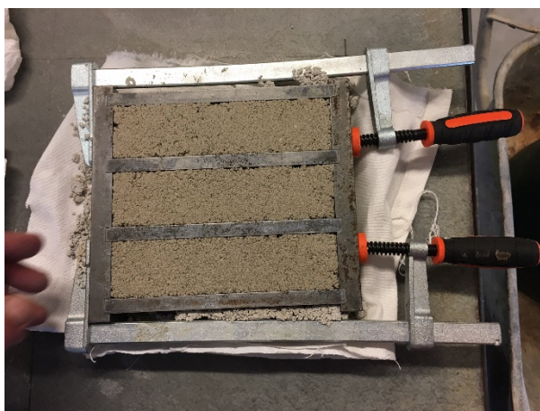
Figuur 2.1: Aangevulde rvs-mal met specie
