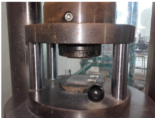
Figuur 3.3: Drukbank met opzet voor druksterkte conform NEN-EN 1015-11.
