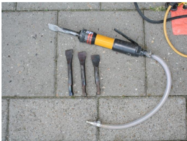
Figuur 2: Conditie en staat van het gereedschap. Beitels van de hakhamers worden zelf gemaakt in het eigen bedrijf.
