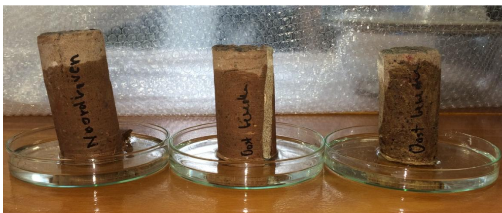
Figuur 30: Wateropzuiging in de boorkernen na 120 minuten.
