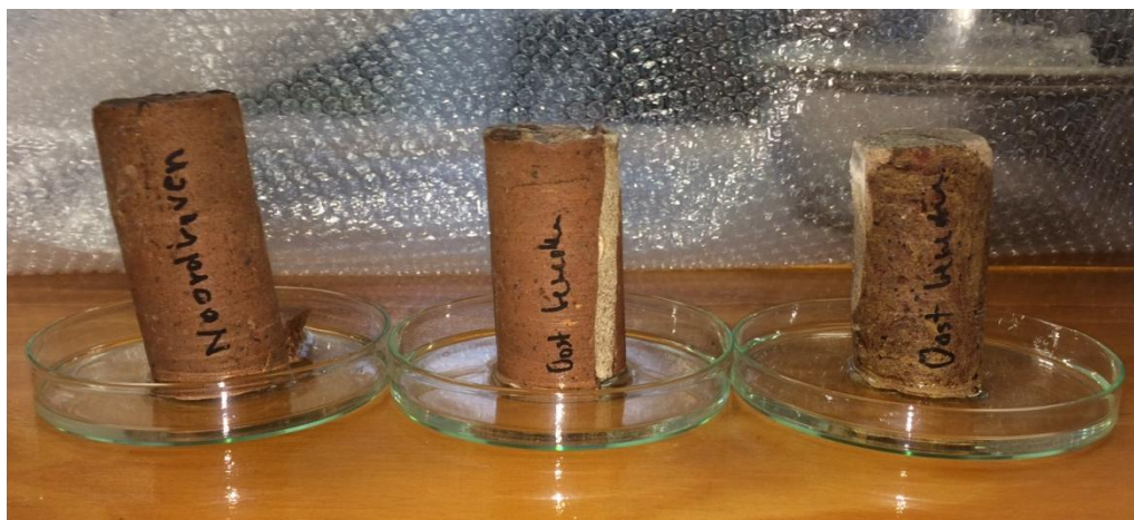
Figuur 31: Wateropzuiging in de boorkernen na 24 uren.
