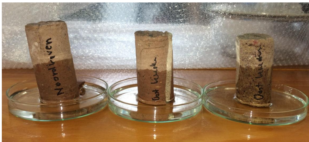
Figuur 28: Wateropzuiging in de boorkernen na 30 minuten.
