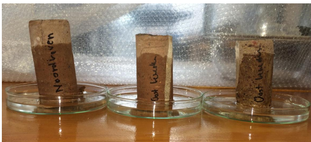
Figuur 29: Wateropzuiging in de boorkernen na 60 minuten.
