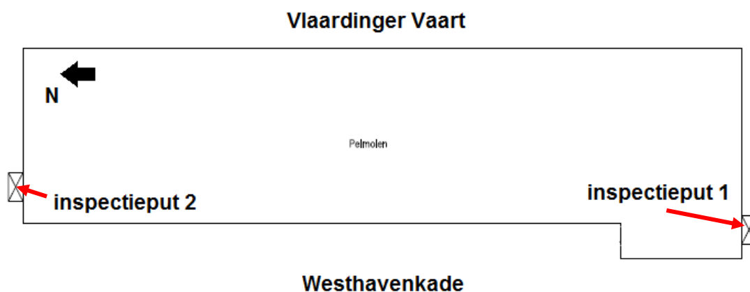
Figuur 11: Locaties funderingsinspectieputten aan de noord- en oostgevel van De Pelmolen
