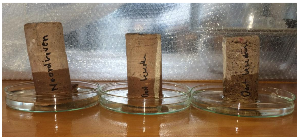
Figuur 27: Wateropzuiging in de boorkernen na 10 minuten.
