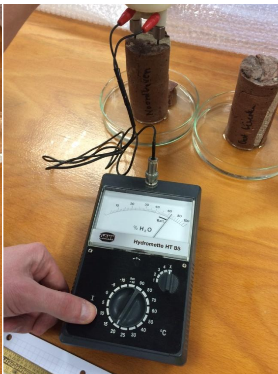
Figuur 34: Indicatieve vochtmeting op monster noordgevel boven (oppervlakte nat); gemeten RV 68%.
