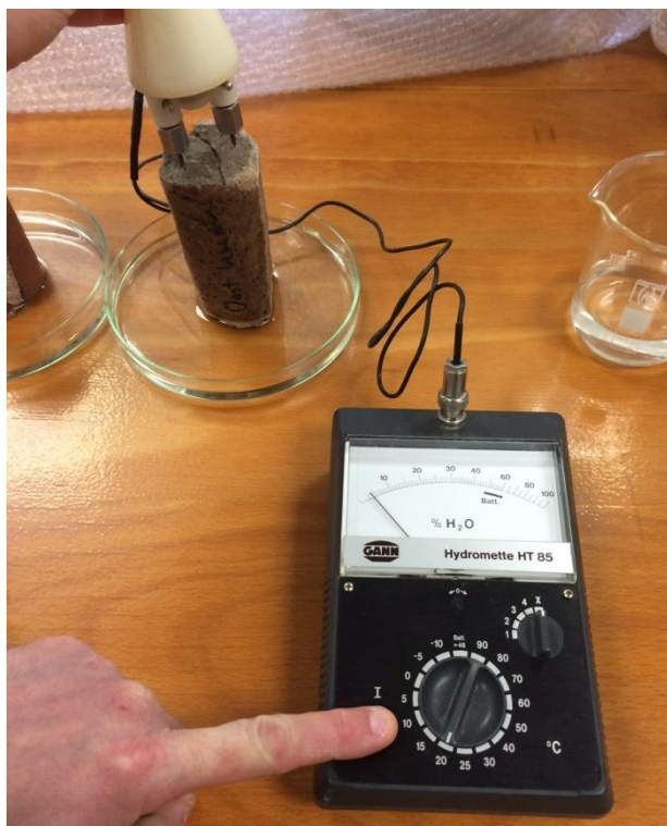
Figuur 33: Indicatieve vochtmeting op monster oostgevel (oppervlakte droog); gemeten RV 3,6%.
