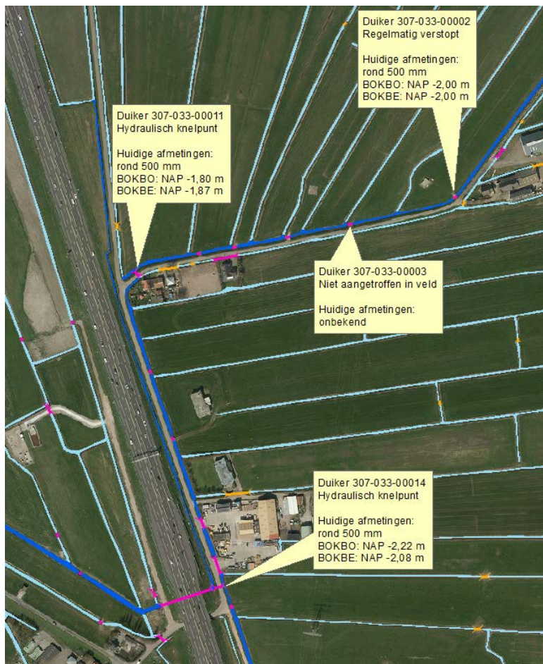
Figuur 5.1: Knelpunten duikers watersysteem Inlaagpolder
