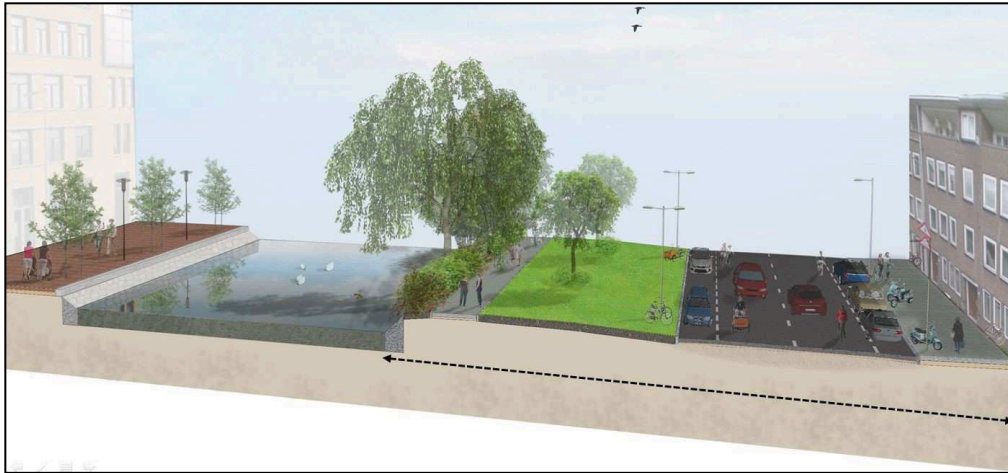
Figuur 4: Illustratieve doorsnede van de Linnaeuskade. De kruin van de waterkering ligt ter plaatse van het voetpad in de groenstrook.
