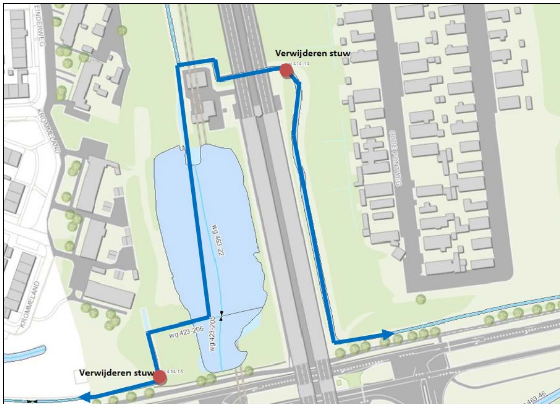
Figuur 6.1: Verwijderen stuw st414-14 en st414-15. Hierdoor ontstaat er een alternatieve afvoerroute van west naar oost
