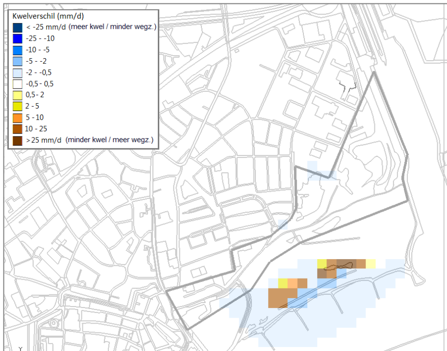
Afbeelding 3.5: Effect van het niet afdichten van de geulen t.o.v. het wel afdichten ervan
