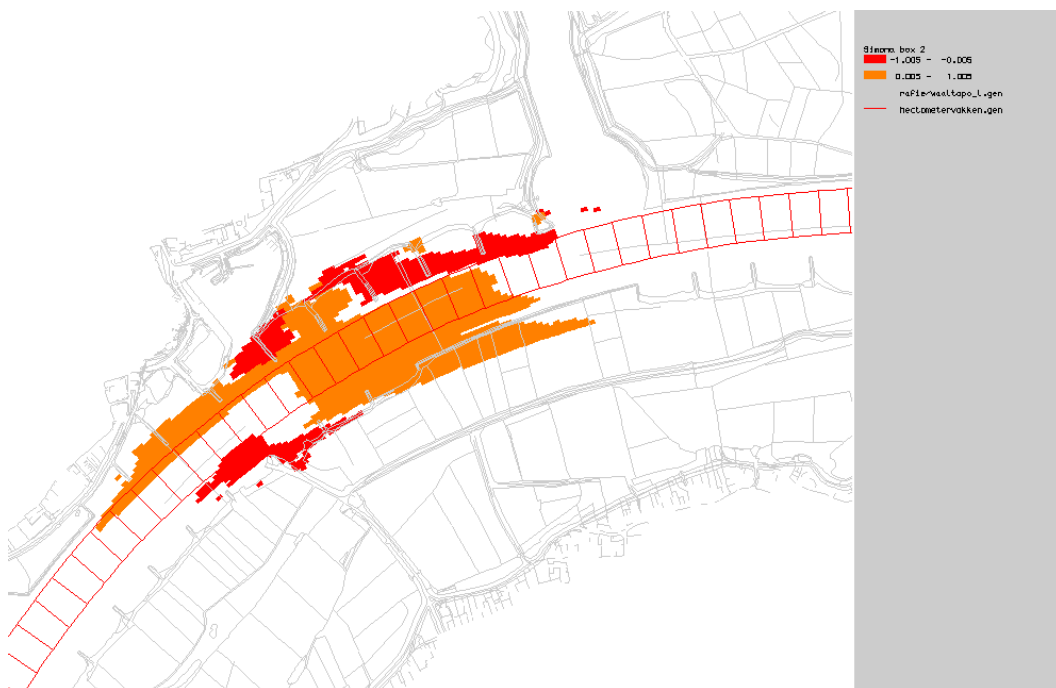
Afbeelding 29: Maximale erosie (rood) en sedimentatie (oranje) [m] a.g.v. kwp71, gebaseerd op een afvoer van 6.000 m 3 /s bij Lobith.
