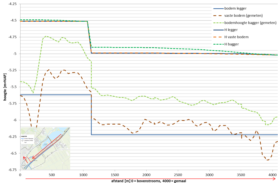
Figuur 5.1: zijaanzicht gemeten profielen en leggerprofielen
