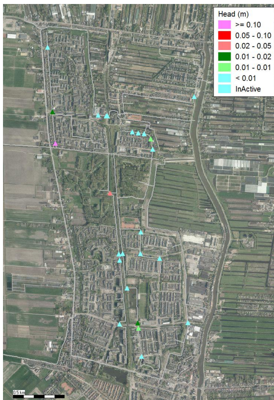
Figuur 10: Berekende opstuwing kunstwerken (bruggen en duikers) bij winterpeil
