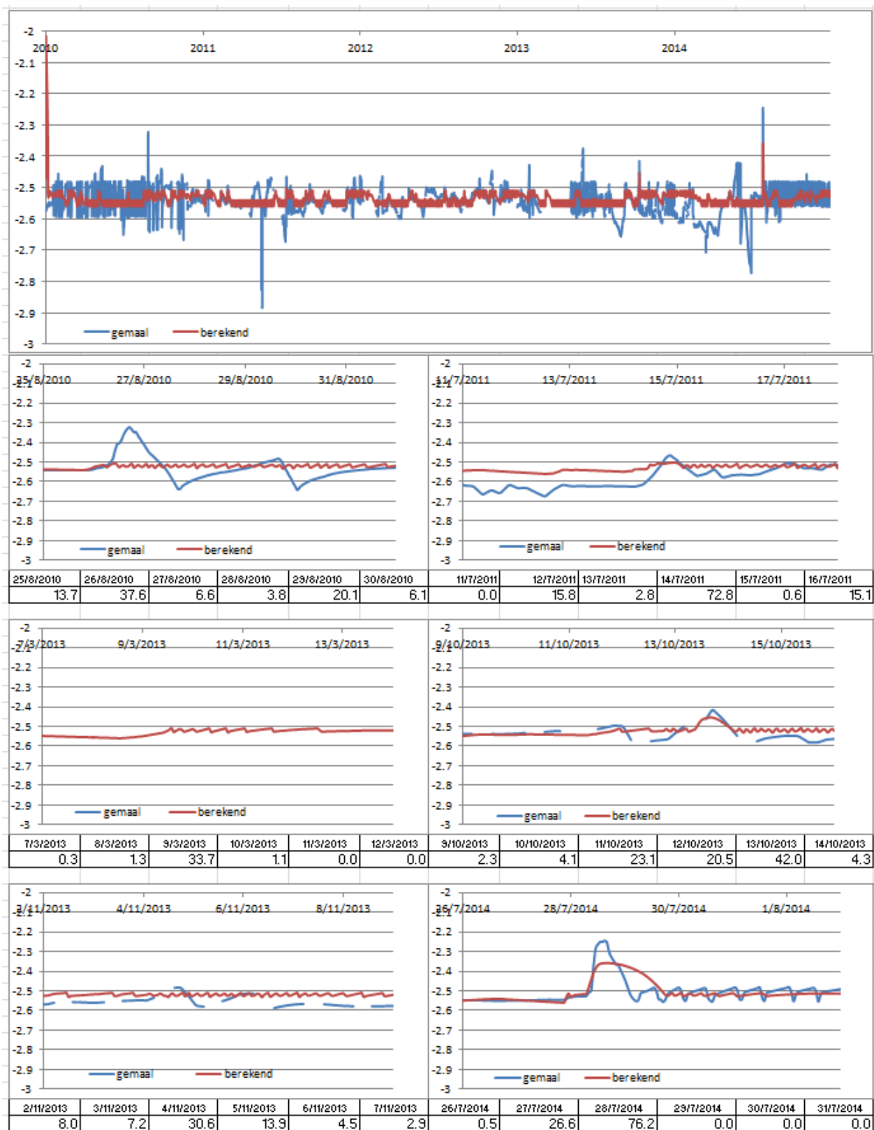
Figuur 7 : Berekende en gemeten waterstanden (bij gemaal) voor peilvak WW-42C
